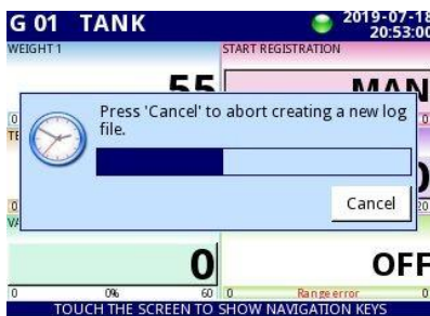
Hình 7.48. Ví dụ về thông báo về khả năng hủy tạo tệp dữ liệu mới
