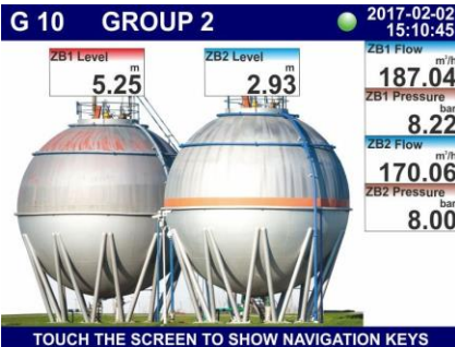
Hình 7.153. Ví dụ về hình ảnh hóa SCADALite
