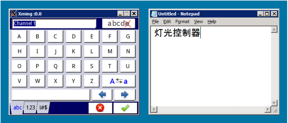
Hình 7.14. Cửa sổ Xming với tên kênh logic được mở để chỉnh sửa và cửa sổ Notepad với văn bản được chuẩn bị để thay thế tên đó
