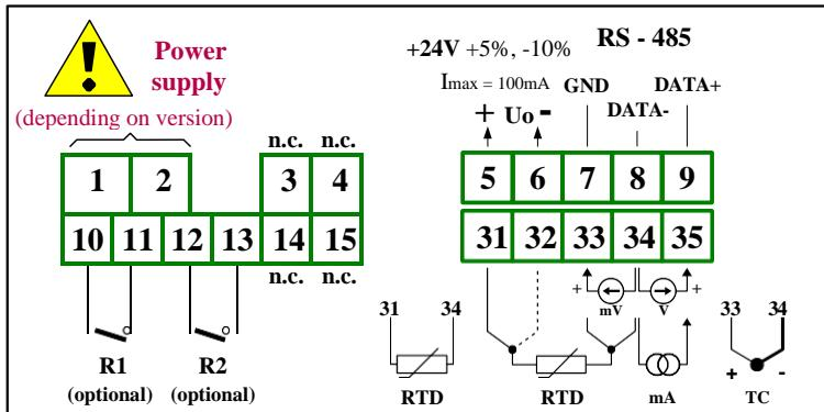
Hình 4.5. Thiết bị chân kết nối (hai ngõ ra relay)
