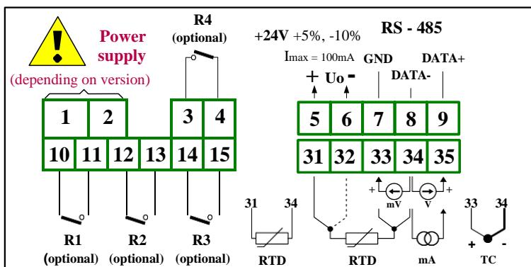
Hình 4.7. Thiết bị chân kết nối (bốn ngõ ra relay)
