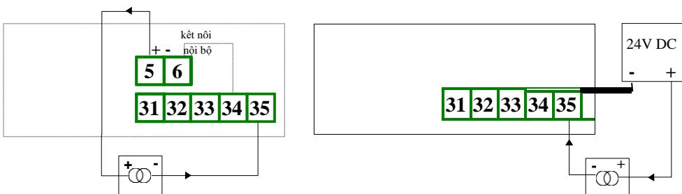
Hình 4.12. Kết nối bộ chuyển đổi dòng điện 2 dây
