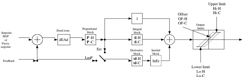
Hình 7.2. Sơ đồ chung của bộ điều khiển PID có trong thiết bị PUR-49D
