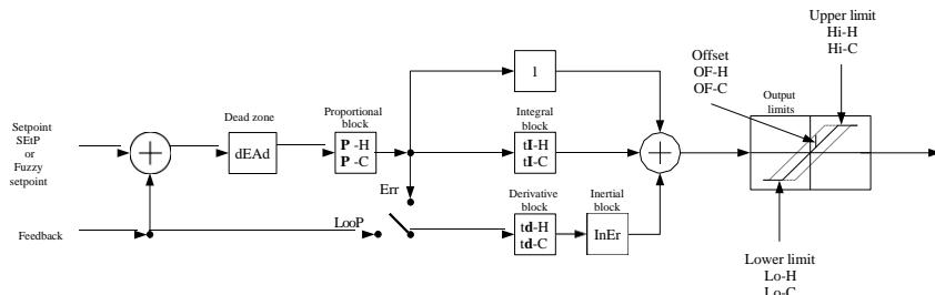
Hình 6.6. Sơ đồ chung của bộ điều khiển PID được triển khai trong thiết bị PUR-49D
