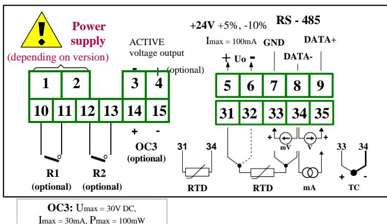
Hình 4.11. Thiết bị chân kết nối (hai role, một loại OC và một ngõ ra điện áp active)
