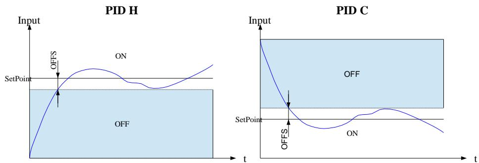
Hình 6.7. Đặc tính điều khiển rơ le tùy thuộc vào chế độ hoạt động
