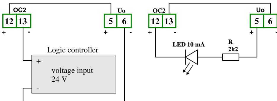
Hình 4.18. Kết nối ngõ ra kiểu OC (chỉ dành cho thiết bị có ngõ ra kiểu OC)
