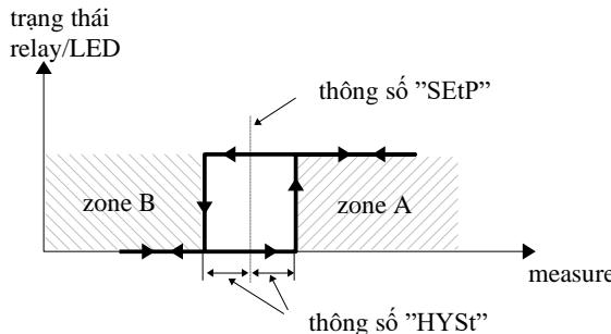
Hình 6.10. Một ngưỡng điều khiển của các ngõ ra rơ le / đèn LED
