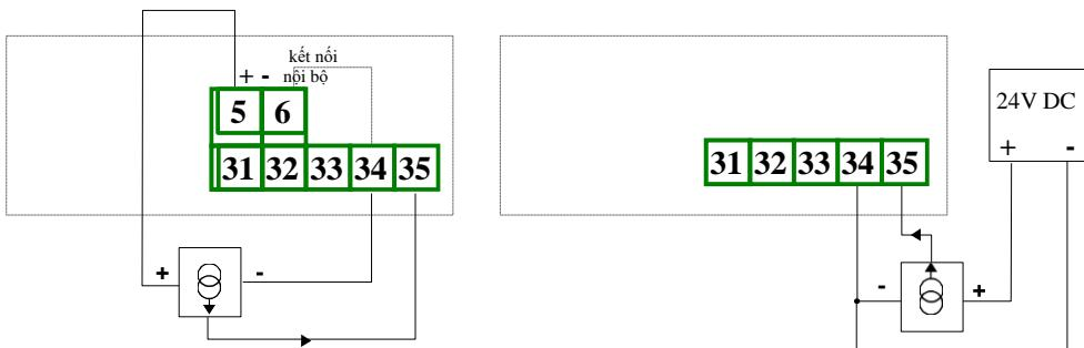
Hình 4.13. Kết nối bộ chuyển đổi dòng điện 3 dây
