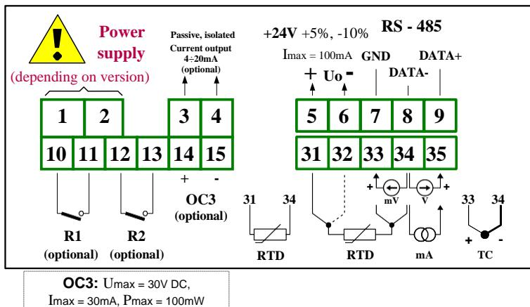
Hình 4.10. Thiết bị chân kết nối (hai role, một ngõ ra loại OC và một ngõ ra dòng thu động)
