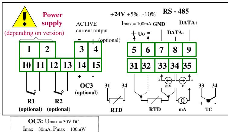
Hình 4.9. Thiết bị chân kết nối (hai rơ le, một loại OC và một ngõ ra dòng điện active)
