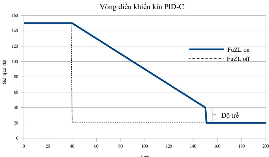
Hình 6.9. So sánh phản ứng của bộ điều khiển PID-C đối với sự thay đổi trong điểm đặt bằng cách sử dụng và không sử dụng logic mà
