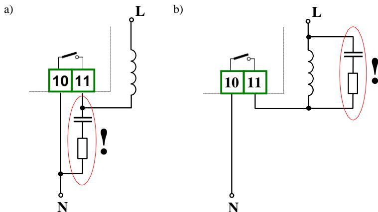
Hình 4.17. Kết nối mạch triệt tiêu:
