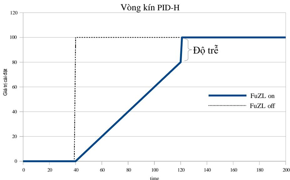
Hình 6.8. So sánh phản ứng của bộ điều khiển PID-H đối với sự thay đổi trong giá trị cài đặt bằng cách sử dụng và không sử dụng logic mờ
