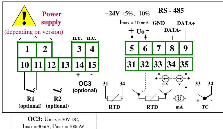
Hình 4.8. Thiết bị chân kết nối (hai rơ le và một ngõ ra loại OC)
