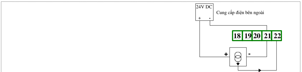
Hình 4.12. Kết nối bộ chuyển đổi dòng điện 3 dây
